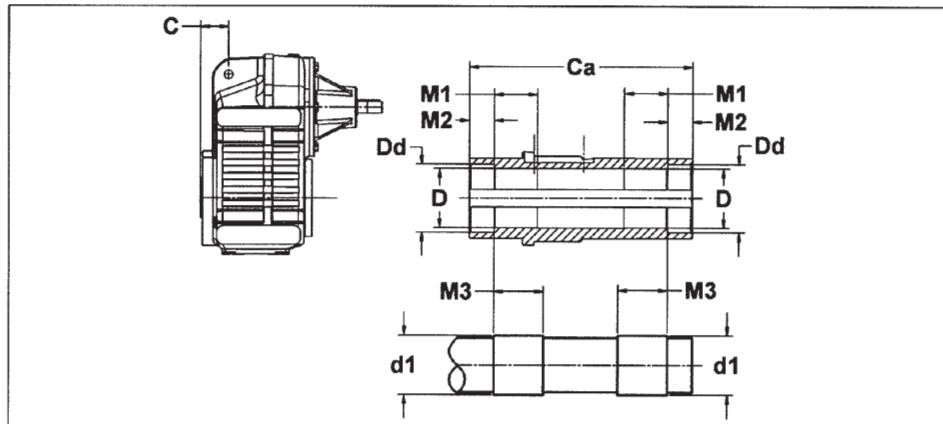
Výstupní hřídel s drážkou pro pero
