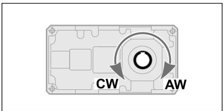
**V převodovkách s blokací zpětného směru otáčení je nezbytné použít syntetický olej viskozitní třídy ISO 150.**
