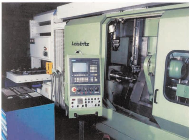
CNC-Wirbelmaschine "LEISTRITZ" mit Ladeeinrichtung
